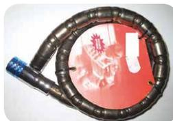
mure d'acier articulée, **quoique jamais jusqu'au niveau 2 roues**. Une différence notable entre les antivols a été mise en évidence, liée à la qualité du sertissage du câble au niveau du boîtier de serrure et de la trempe et cémentation de la coque en acier.
